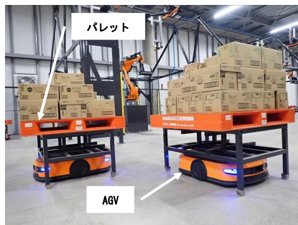
【自動化設備制御システムイメージ】
